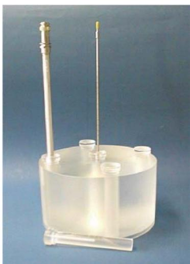
Рис 2: AL калибровочный фантом T9193 с твердотельной камерой (слева) и AL аппликатором
