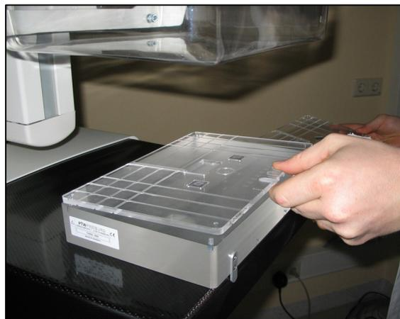
Рис. 2: Размещение структурной панели фантома **NORMI MAM**
