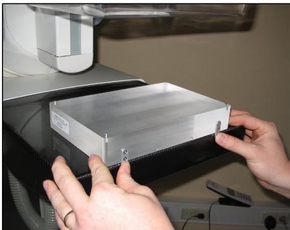
Рис. 1: Размещение ослабляющей пластины **NORMI MAM**
